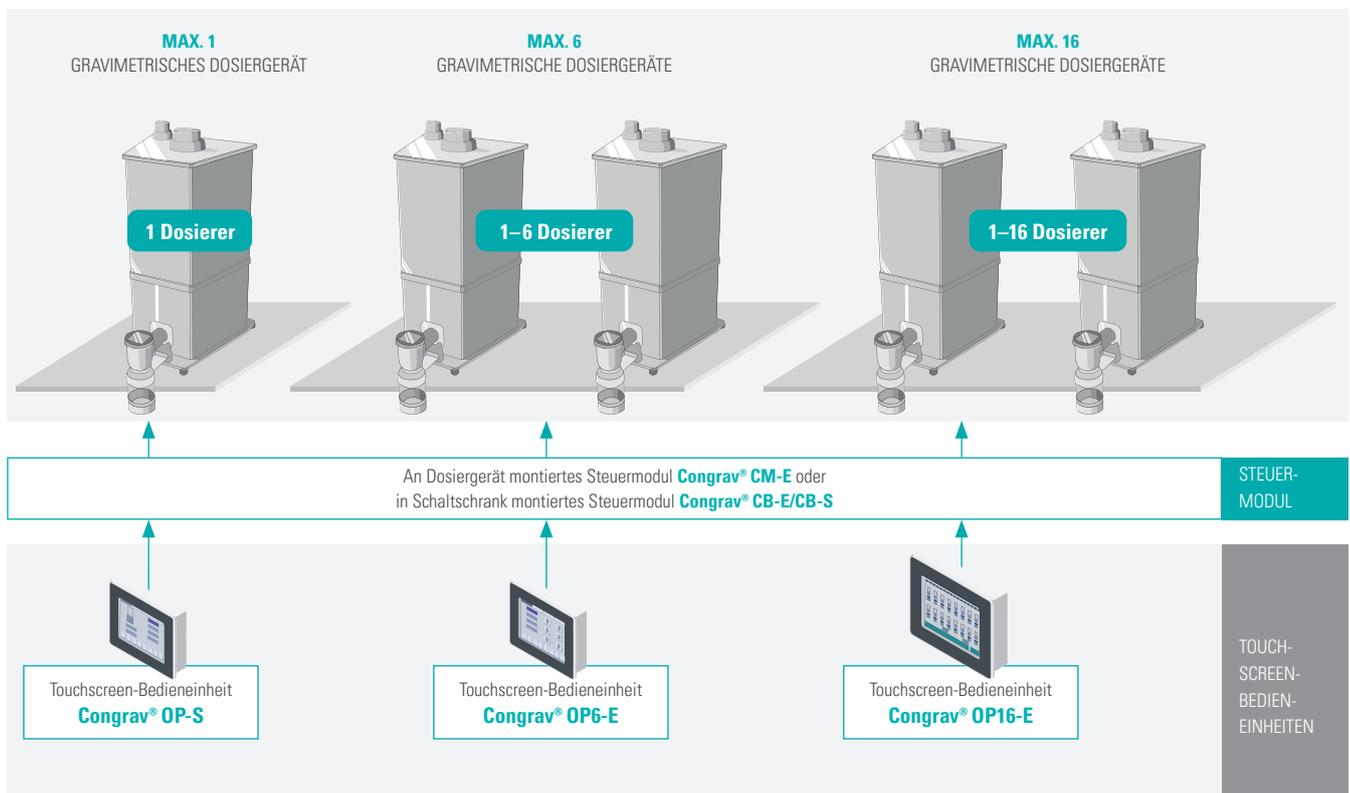
Steuerungslösung für mehrere gravimetrische Dosiergeräte mit am Dosiergerät montierten Steuermodulen (Steuerung über direkten Anschluss an ein Host-/SPS-System oder über eine Touchscreen-Bedieneinheit)
