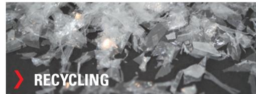
Heterogen, schwerfließend und in Form und Größe äußerst unterschiedlich: Bei der Zerkleinerung von Wertstoffen entsteht ein Mahlgut, das anspruchsvoll zu handhaben ist. Dank unserer spezialisierten Technologie dosieren unsere Geräte zuverlässig selbst lange, ungleichmäßig geschnittene und nicht fließfähige Fasern.
